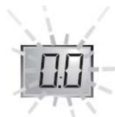
b) Через 1 секунду после выбора пункта меню и соответствующего ему режима управления дисплей начинает мигать, подтверждая переход в настройку режима работы конструкции.
